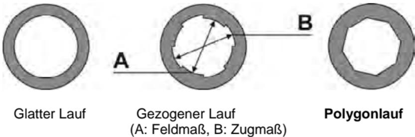
**Polygonlauf:** Im Querschnitt erkennt man bei einem Polygonlauf ein abgerundetes Vieleck (Griechisch *Polygon*). Es setzt sich in einer Drehbewegung spiralförmig durch den gesamten Lauf fort. Das Projektil erhält somit eine Rotation um seine Längsachse, wodurch dessen Flug stabilisiert wird.
